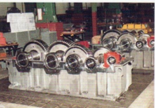
Stirradgetriebe für Brikettiermaschine
