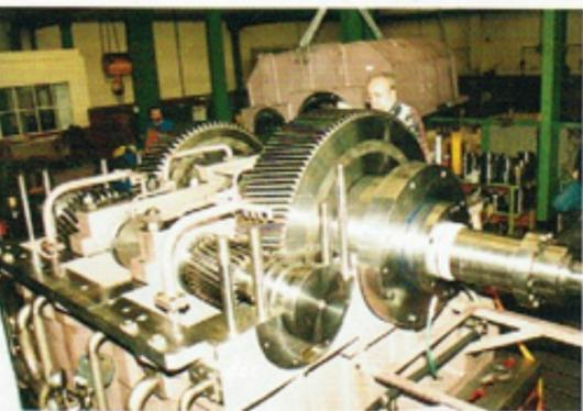
Stirrad-Schaltgetriebe für Auswucht-
