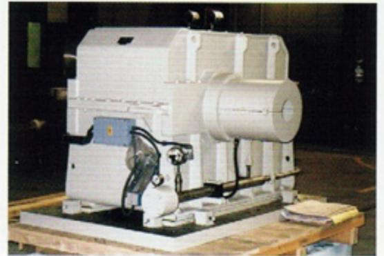
Stirrad-Schaltgetriebe für Prüfstand
