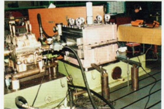
Stirradgetriebe für Auswuchtanlage
